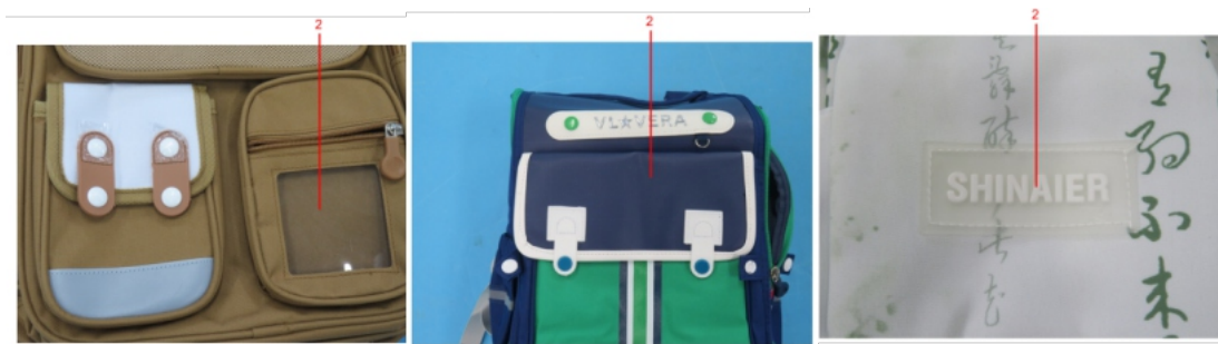
图8: 不同超标点位材质示例（从左至右依次为透明塑料、人造革和装饰性软材料）
