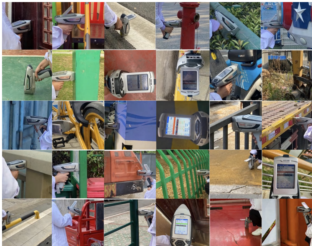
图4.1 研究员正在使用XRF仪器对部分场景进行实地检测
